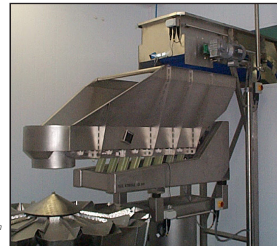
Impulse® Vibrationsförderer zum Beschicken von Waagen mit Siliergut
