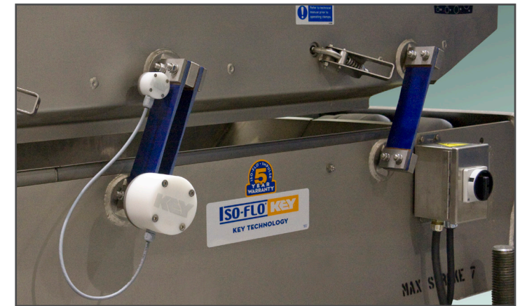
Installation von SmartArm® auf Iso-Flo®
